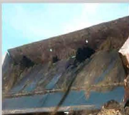
*Очищаем поверхность от намерзшего/налипшего материала, поверхность должна быть ровной, без значительных отклонений от плоскости, которые не сможет повторить футеровочная пластина.*
