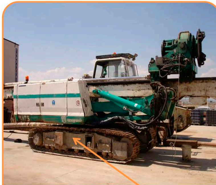
СУЭК (Разрез Харанорский) Втулки на ходовой СБР-160А-24 (29 т.), используется ZX-100K со смазкой.
