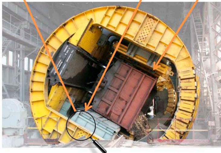
Футеровка бункера вагонопрокидывателя INKULEN
