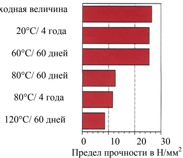
Предел прочности при растяжении и сдвиге в зависимости от температуры DIN53283
