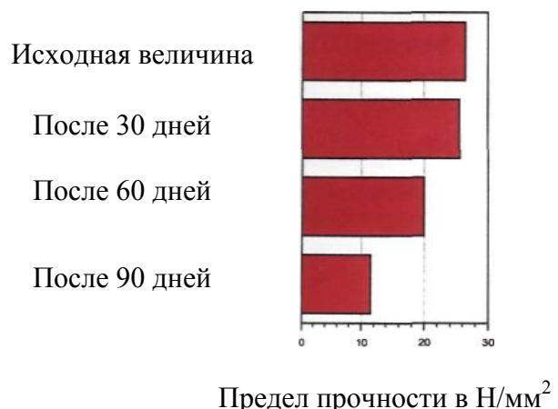
Предел прочности при растяжении и сдвиге после длительного температурного воздействия.
