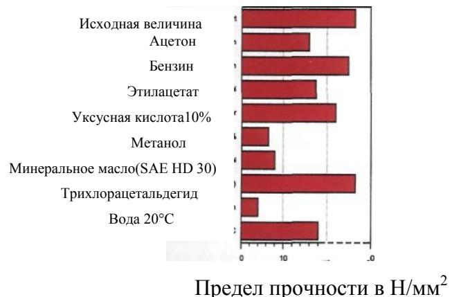
Предел прочности при растяжении и сдвиге после хранения в тропическом климате(40/92) DIN50015
